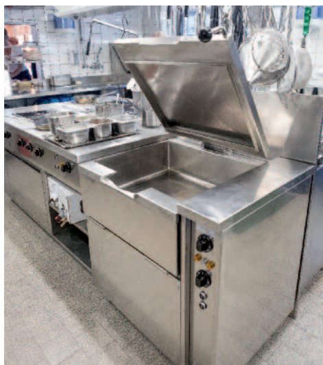
Im Mittelpunkt der von der Gamatech AG (Illnau) konzipierten und realisierten neuen Hecht-Küche steht eine beidseitig bedienbare multifunktionale B-G-H-Herdanlage mit sechs Induktionskochfeldern, Bain-Marie, Mixer-Halterung, Multifunktionskippratpfanne und Doppel-Standfritteuse.
